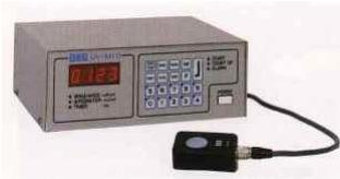
2. 將 Sensor 感應頭固定於玻璃上方由機台入口端置入，由 Rolls 搬送流過光源（請注意感應頭厚度是否會撞到燈管），以測量  $mJ/cm^2$  的 UV 總累積光量。但以上測量方式在測量 ON LINE 型生產線時會因為隧道型機構上下游入口與出口不是在同一處，而 Meter 本體又因為太大，LCD 視窗、塑鋼製外殼不耐 UV 光破壞而無法一起通過 UV 模組下方，此時只好等測量完畢時再由出口端拉回 Sensor 感應頭，但是要注意連接線長度是否足夠及拉回時產生碰撞、磨損的問題。
