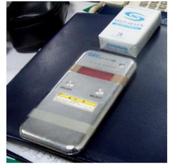
光破壞外還方便置於工作物旁一起經由搬送單元流向 UV 燈的下方，以測量 UV 燈的發光能量，等它與工作物由出口端流出後再讀取 LCD 顯示幕上秀出的  $mW/cm^2$  的最高值或  $mJ/cm^2$  的總累積光量。
