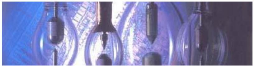
高壓的放電管都有一個共同缺點，由於氣體於高壓時較不容易產生放電，因此若因為突然停電而不再放電時，必須等燈管冷卻（蒸汽變回液態）（約 10~15min）後燈管才有辦法恢復放電狀態，逐漸加熱燈管後恢復正常工作狀態。
