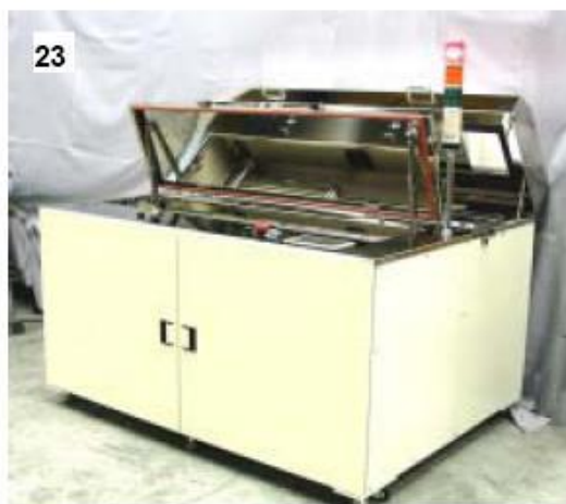
図 24. 25. 水晶振動子やCD読取レンズの洗浄装置。図 23 の手前のトレーに製品を並べ、図 22 奥の光源(開いている)の下に送って照射する。
