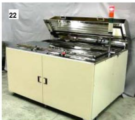
図 24. 25. 水晶振動子やCD読取レンズの洗浄装置。図 23 の手前のトレーに製品を並べ、図 22 奥の光源(開いている)の下に送って照射する。
