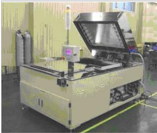
圖 5. 光增感型枚葉式基板 Film 處理機 靠近自己這邊裝入 Film，在深處照射。
