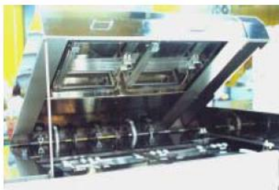
図 26. プラズマテレビ端子洗浄装置の光源。 ディスプレイの周辺だけを照射する。
