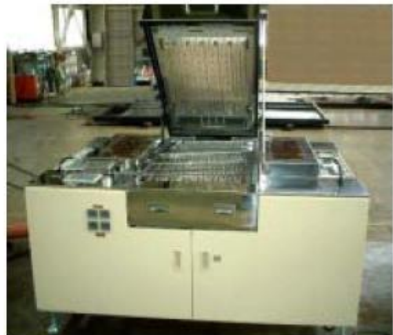
図 17. 微細 PCB 電解メッキ前処理全景
